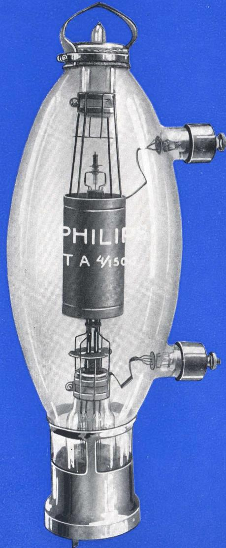
Diese Röhre liefert auch schon bei verhältnismässig niedriger Anodenspannung eine grosse Nutzleistung. Die Anodenspannung darf bis zu 5000 V betragen, vorausgesetzt, dass der zulässige Anodenverlust von 750 W nicht überschritten wird.
